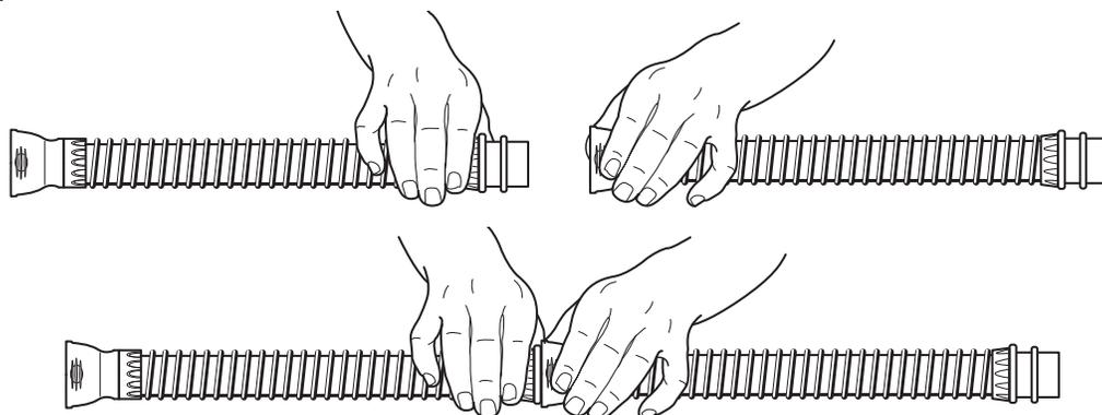
Raccordez la section de boyau de 2 pieds à l'adaptateur mural et l'assemblage Star Control à l'extrémité opposée de cette même section.
