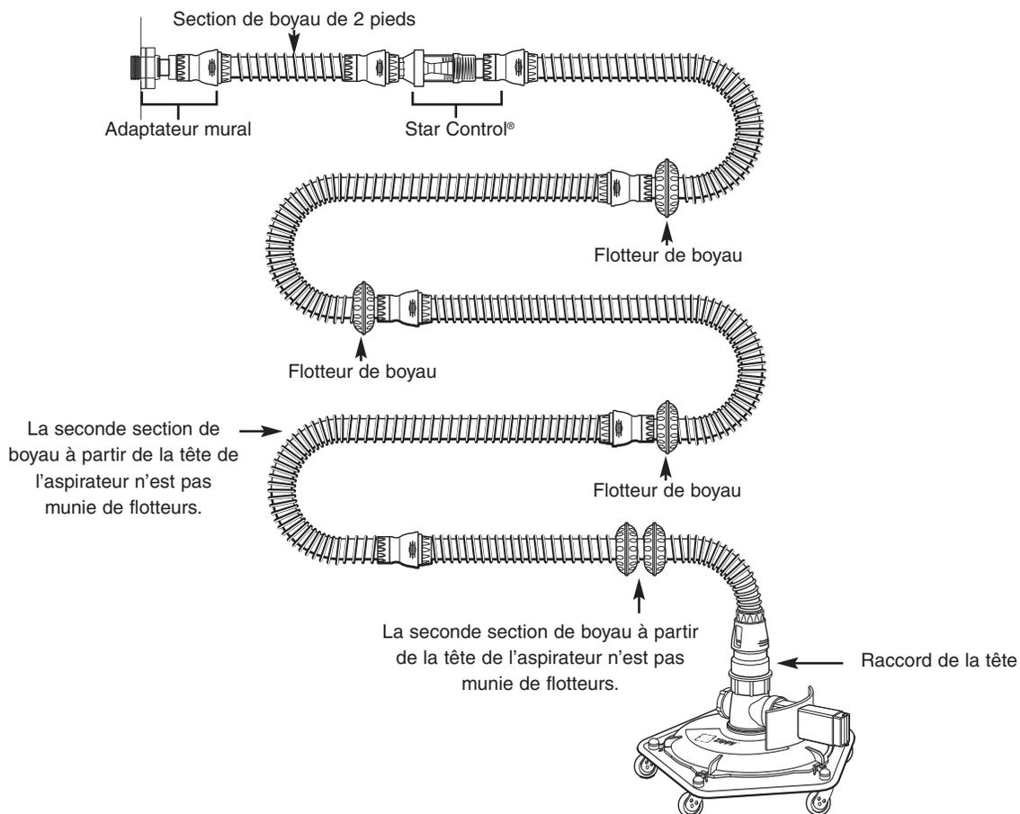
Vissez le raccord de la tête qui est rattachée à la première section de boyau à la tête de l'aspirateur. Plongez la tête du ZIPPY® dans la piscine, penchez-le sur le côté et agitez-le d'avant en arrière, jusqu'à ce que l'air en soit évacué et que les bulles s'en échappent. Faites descendre le Zippy au fond de la piscine.
