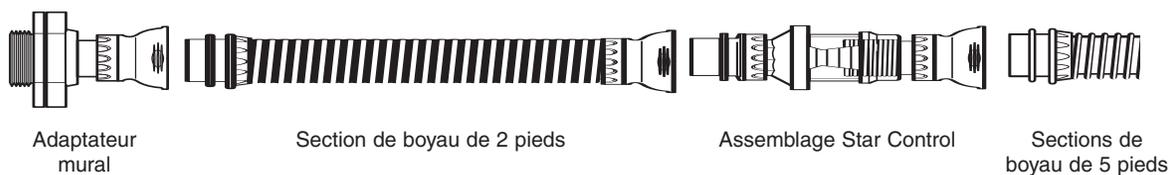
Selon l'ordre approprié, raccordez le nombre de sections de boyau de 5 pieds nécessaires à votre piscine à l'assemblage Star Control. Le boyau et les flotteurs de boyau doivent être assemblés tel qu'indiqué ci-dessous, afin que le Zippy fonctionne correctement.
