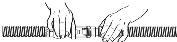
Tournez lentement l'écrou de réglage dans le sens des aiguilles d'une montre pour augmenter le débit dirigé vers l'aspirateur ou dans le sens contraire des aiguilles d'une montre pour réduire ce débit. Ajustez l'écrou de manière à ce que le trait indicateur vert se trouvant à l'intérieur du Star Control s'aligne sur la bande jaune de la jauge indicatrice.
